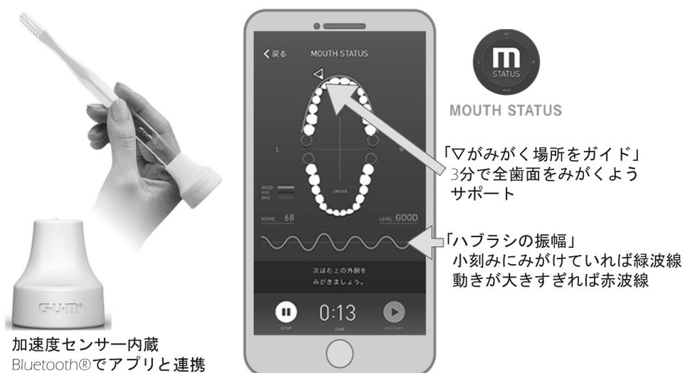
図1 デジタルブラッシング指導デバイス（G・U・M PLAY<sup>®</sup>）の仕組みと機能
